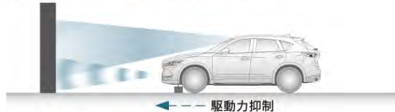
■ ペダル踏み間違い急発進等抑制装置
