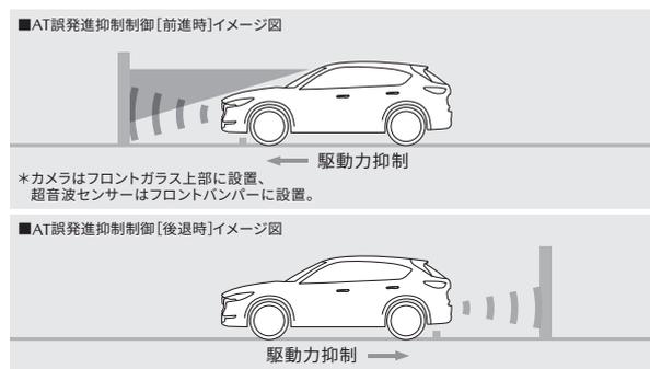
ペダルの誤操作による急発進を抑制する
